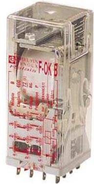
Le F-OK B 400 est un relais électromagnétique instantané, tout-ou-rien, doté de 4 contacts inverseurs à double coupure en série. Il allie performances, robustesse et facilité de montage, ce qui le destine plus particulièrement aux utilisations requérant une grande sécurité et une excellente fiabilité de coupure, pour des charges moyennes. Matériel ferroviaire roulant ou statique, marine, transport et production d'énergie électrique... constituent pour le F-OK B des domaines de prédilection
